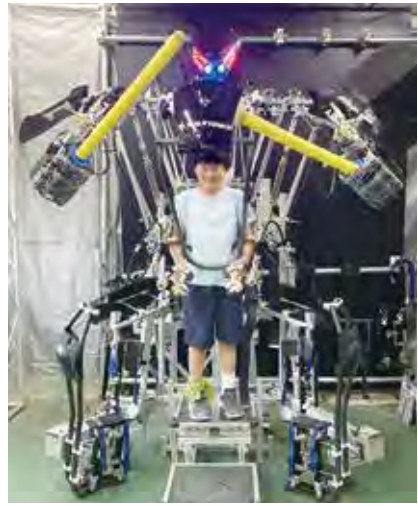
▲スケルトニクス® 装着した人の動きに合わせて動く身長約3mのエンターテインメントロボットです。
