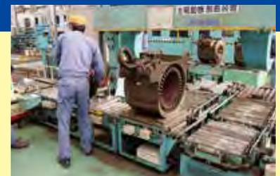
電車を動かすモーター(主電動機)も台車から取り外して整備します。10両編成の電車は約20台のモーターで動かしています。
