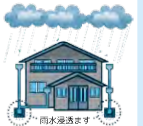
雨水浸透ます
