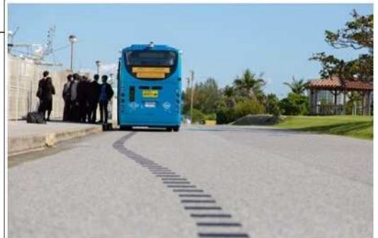
図 幹線道路上に磁気マーカー等を設置し実施された自動運転バスの実証実験（沖縄県那覇市・豊見城市）の例
