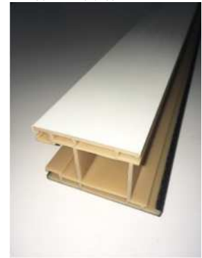
竹CNF含有塩ビコンポジット押出成形品 [CNF7wt%混合]
