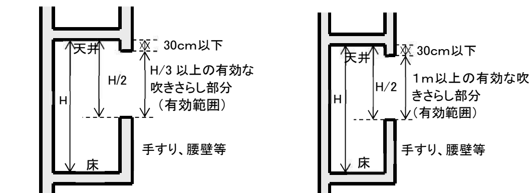
有効な吹きさらしの部分が 天井高の1/3以上あるもの（例）
