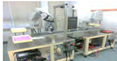
複数種類の部品を認識して取り置く産業用ロボット
