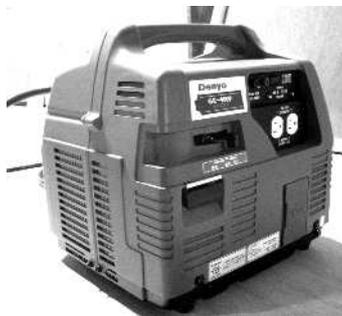
※ この発電機は電圧等が安定するタイプであるため、通信機器など電子機器類の電源として活用することが可能です。
