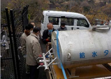
給水タンクの設置・固定 トラックに給水タンクを設置し、トラックに固定します。
