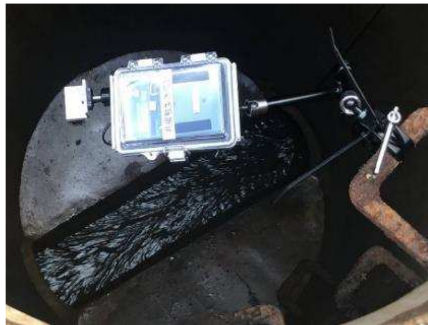
写真 低コスト水位計の設置イメージ (人孔ステップ最上段に取付)
