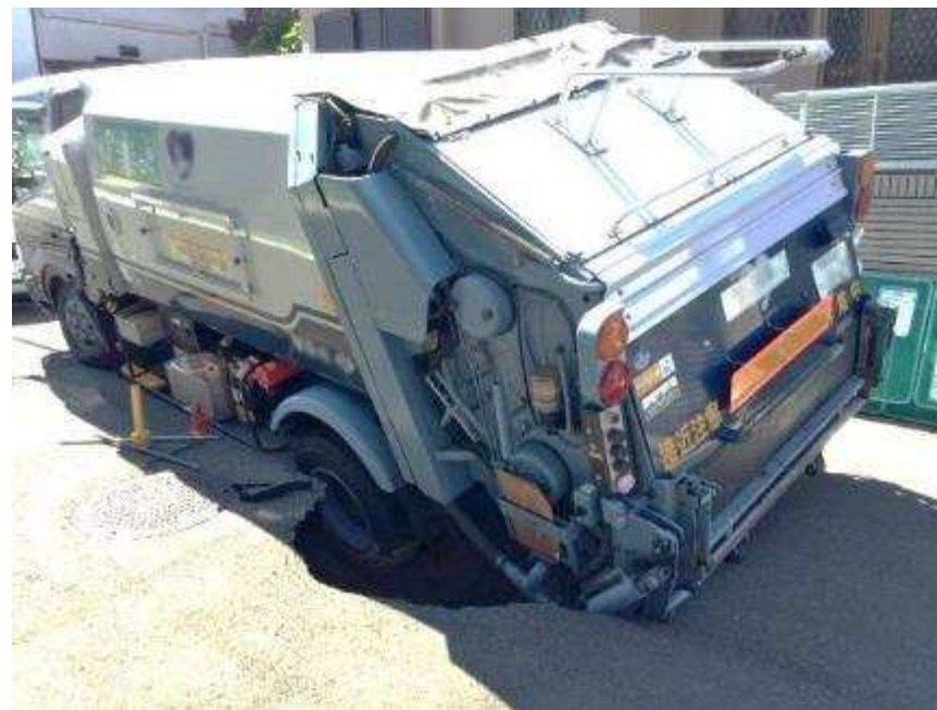
人孔底盤の欠損が原因
