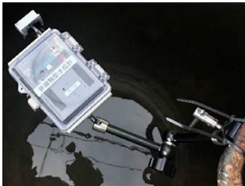
写真 低コスト水位計の設置イメージ (人孔ステップ最上段に取付)
