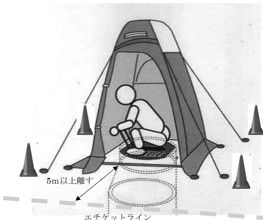
災害用マンホールトイレは、原則、各地域の公共施設等に設置された汚水マンホールふたを、専用の災害用トイレふたに交換することにより使用するものであり、水洗トイレが利用できない場合にご利用いただくものです。
