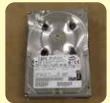
ハードディスクの破壊(穴あけ)例
