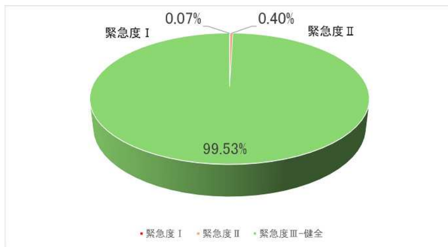
図 1-16 管路施設の点検延長に対する緊急度の割合
