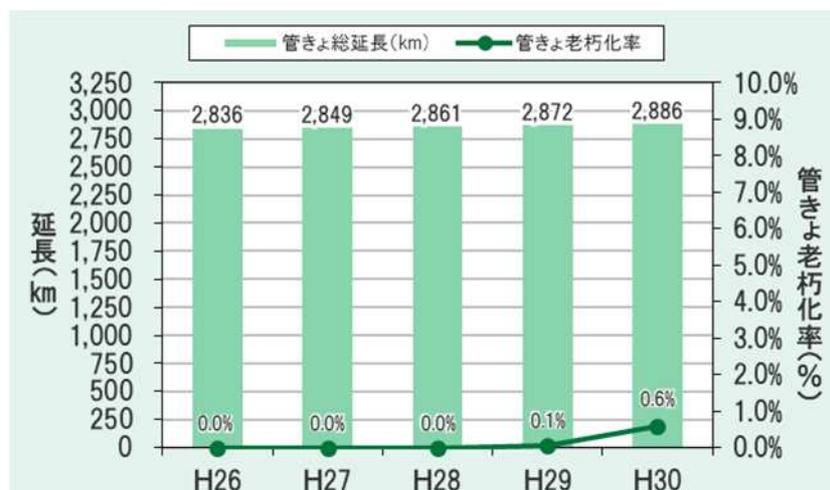
図 6-7 管きよ老朽化率の推移
