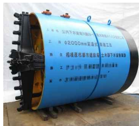
雨水幹線整備工事で使用した推進機械
