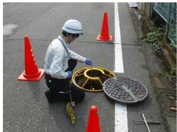
汚水マンホールからの採水作業
