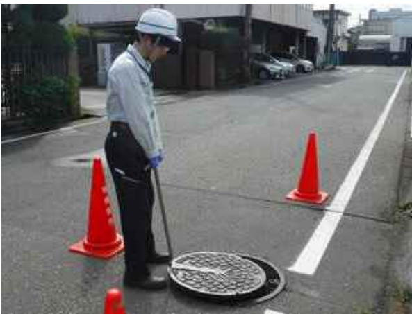
汚水マンホールからの採水作業
