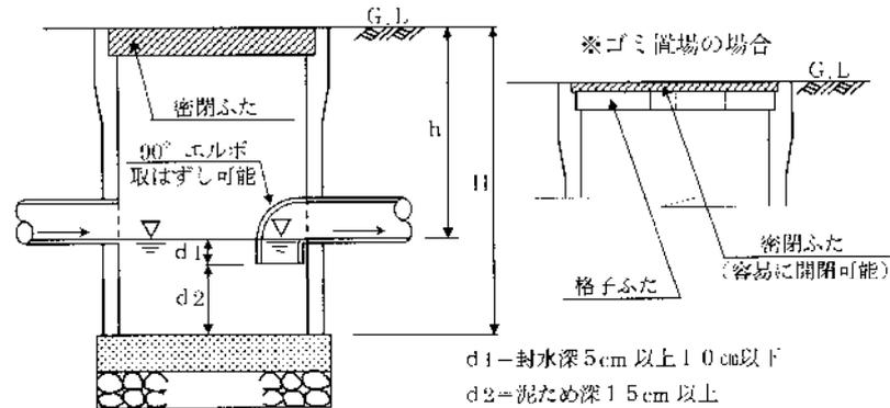
※ ごみ置場については、コンクリートたたきの勾配は、沈殿ますにとらず道路側にとるとともに、沈殿ますについても、雨水が入らない、容易に開閉ができる二重ふたの構造とすること。
