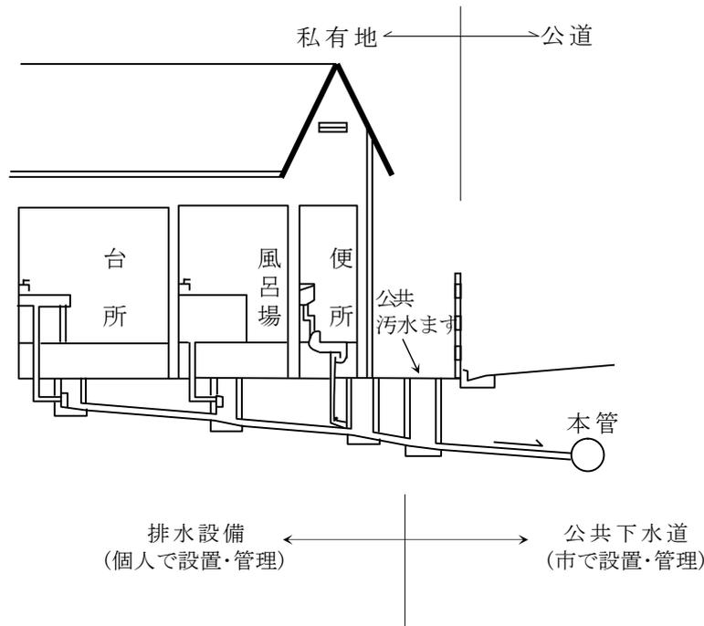
(\*) 本市の公共下水道は、汚水と雨水を別々に流す分流式（一部合流式）を採用している。
