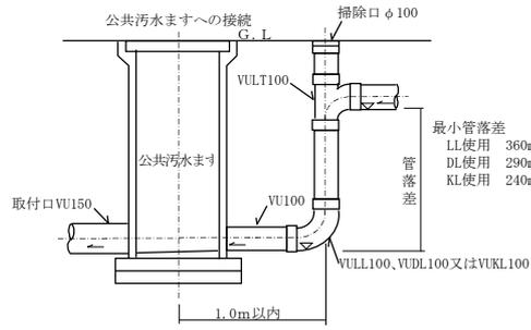
掃除口式ドロップ 標準施工図-2
