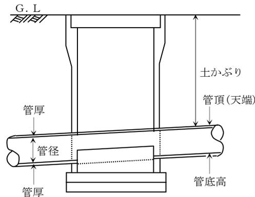
※ 土かぶり = 地盤高 - (管底高 + 管径 + 管厚)
