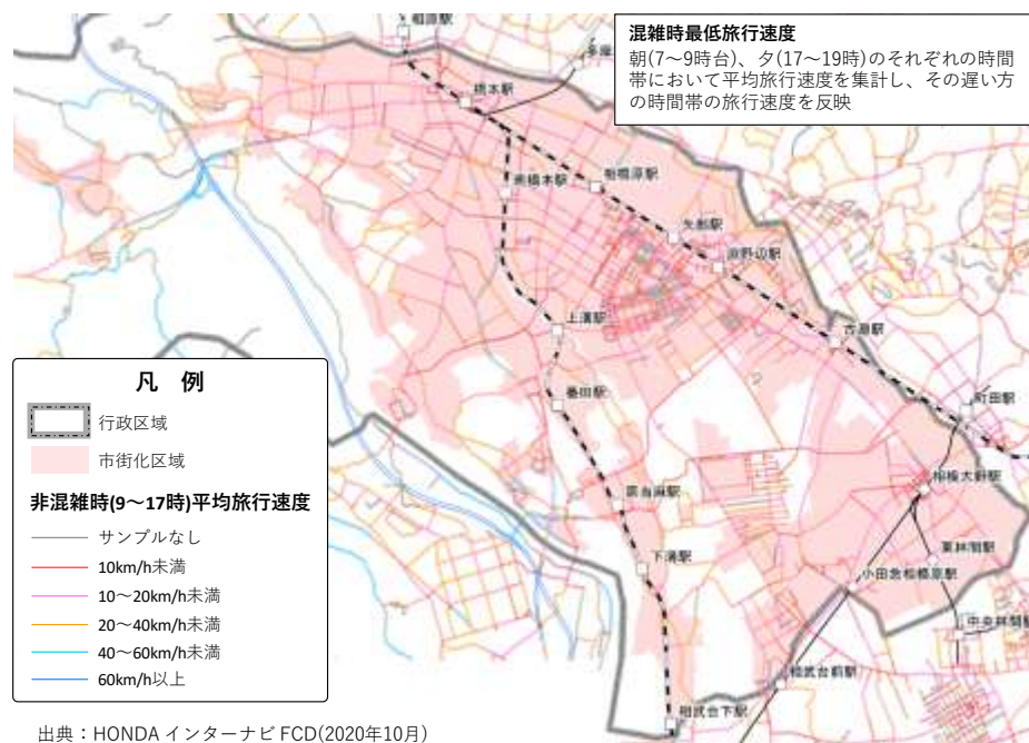
図20 民間プローブデータによる本市の渋滞状況の可視化
