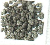
飛灰固形化装置 (ガスの中の炭を薬とセメントで固める)
